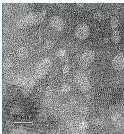
Figura 4 - Immagine TEM ad alta risoluzione di una regione all'interno di una piastrina di Y_2O_3 ottenuta per idrolisi controllata. Si notino i piani reticolari che si estendono sull'intera piastrina e la presenza di pori
