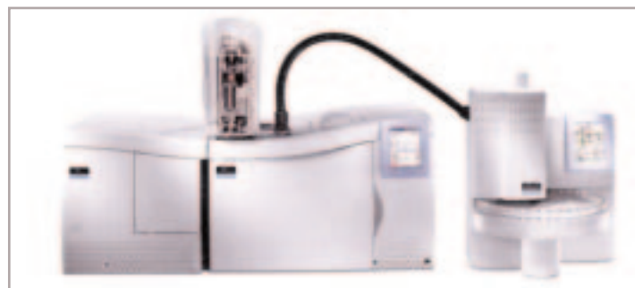
Fig. 10 - Una modernissima unità GC Clarus 500: sulla sinistra lo spettrometro di massa Turbomass e sulla destra l'unità automatica per l'analisi dello spazio di testa con HS Trap System
