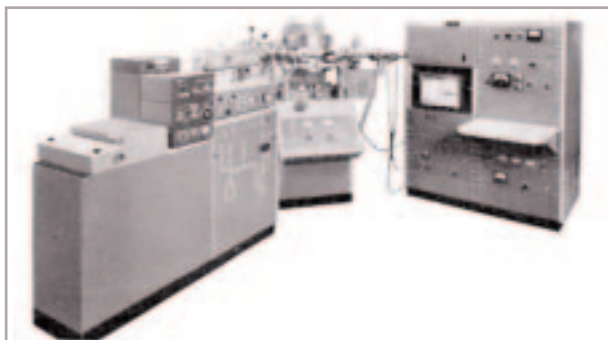
Fig. 4 - Un gascromatografo dell'inizio degli anni '60, collegato con uno spettrometro di massa RMU-6 Hitachi (il gascromatografo è l'unità appoggiata sul banco, sulla sinistra, con a fianco il registratore potenziometrico)
