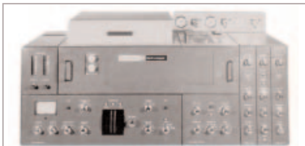
Fig. 5 - Il mod. 900, presentato nel 1967. Poteva montare fino a quattro rivelatori contemporaneamente (la parte destra dello strumento accoglie i cassettei modulari con l'elettronica di controllo dei rivelatori). Alcuni di questi strumenti hanno lavorato per oltre 25 anni
