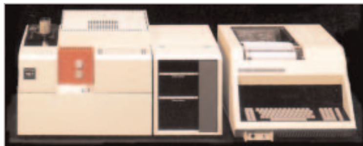
Fig. 6 - Serie Sigma. Presentata nel 1977, comprendeva quattro modelli di gascromatografi e un'unità (sulla destra) di acquisizione, calcolo, registrazione e controllo di più unità cromatografiche. Un vero e proprio calcolatore dedicato alla gascromatografia
