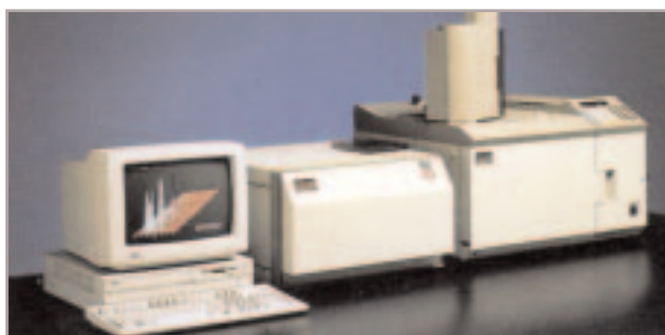
Fig. 8 - La "scatola" sulla destra del PC è lo spettrometro di massa a quadrupolo. Dedicato esclusivamente all'identificazione e alla rivelazione ad alta sensibilità dei componenti separati dal gascromatografo, si diffonde ampiamente grazie al costo contenuto e alla grande facilità operativa
