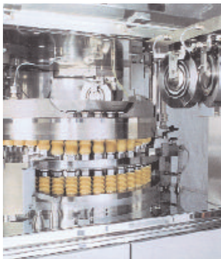
KTS1000: area di compressione con ruote di compressione estratte
