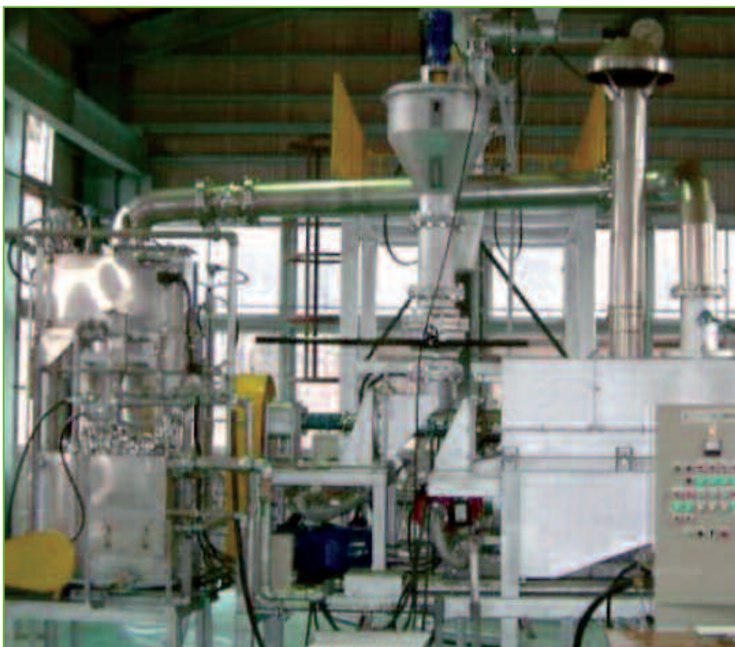
Impianto AIST dimostrativo di un processo a letto fluido per la produzione di olio combustibile
