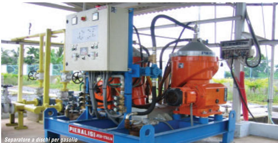
tà e il giunto sull'albero verticale. Generalmente la miscela da trattare è alimentata per mezzo di un tubo stazionario al centro del tamburo. Le fasi liquide separate possono essere evacuate dal separatore verticale per troppo pieno o per mezzo di una pompa centripeta.
