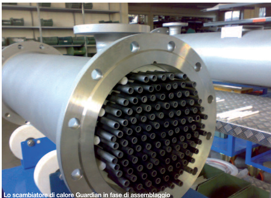
Lo scambiatore di calore Guardian in fase di assemblaggio
