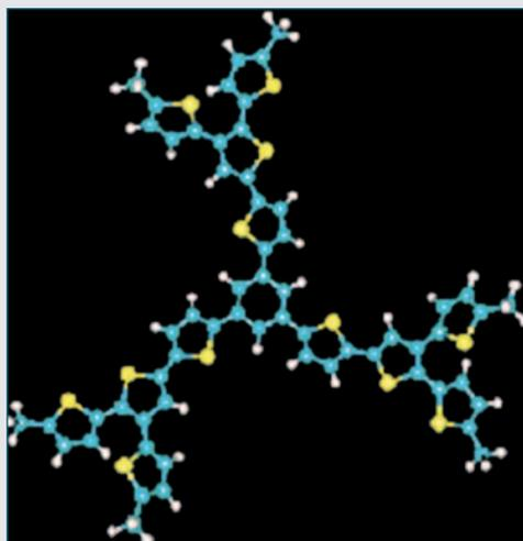
Esempio di molecola dendritica a tre braccia le cui interessanti proprietà spettroscopiche la rendono candidata per la costruzione di dispositivi optoelettronici. Le sue capacità di assorbire ed emettere le radiazioni elettromagnetiche sono state studiate con successo mediante la meccanica quantistica
