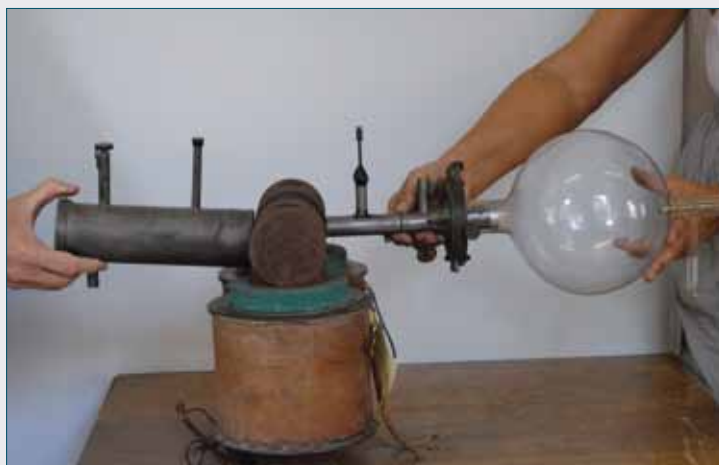
Fig. 1 - Il ritrovamento dello spettrografo di massa di tipo Aston all'Università di Pavia (cortesia del Museo di Fisica, Sistema Museale d'Ateneo, Università di Pavia)
