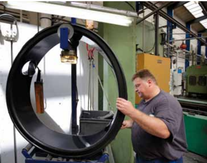
Figura 5: Sbavatura dei Manicotti. Presso Stabilimento di La Roche-Chalais Francia
