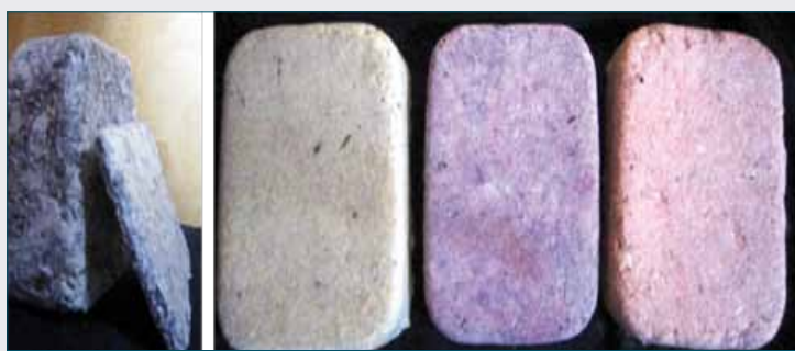
Fig. 3 - Compositi di fibra di canapa e lana di scarto
