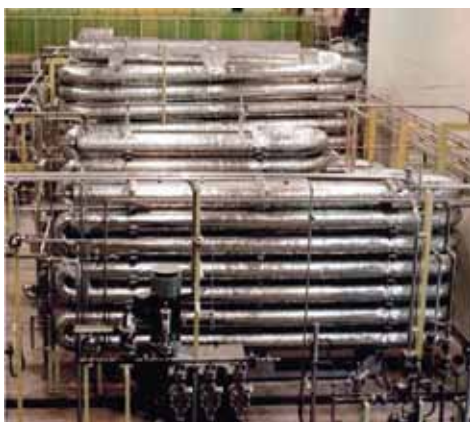
Viste del reattore di tipo “plug flow” tubolare tubo in tubo
