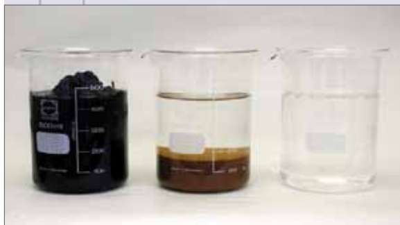
Fango in uscita, dopo filtrazione
