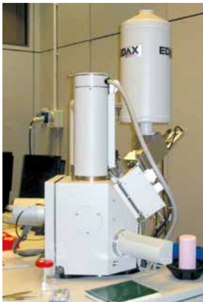
Microscopio elettronico a scansione con microanalisi. Laboratorio Diagnostico per i Beni Culturali Università di Bologna
