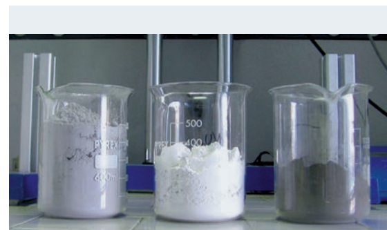
Fig. 2 Il processo COSMOS-RICE: utilizzo di cenere di scarto di diversa tipologia. Da sinistra: ceneri da termovalorizzazione di RSU, ceneri da desolfurazione (FGD) e ceneri da combustione di carbone
