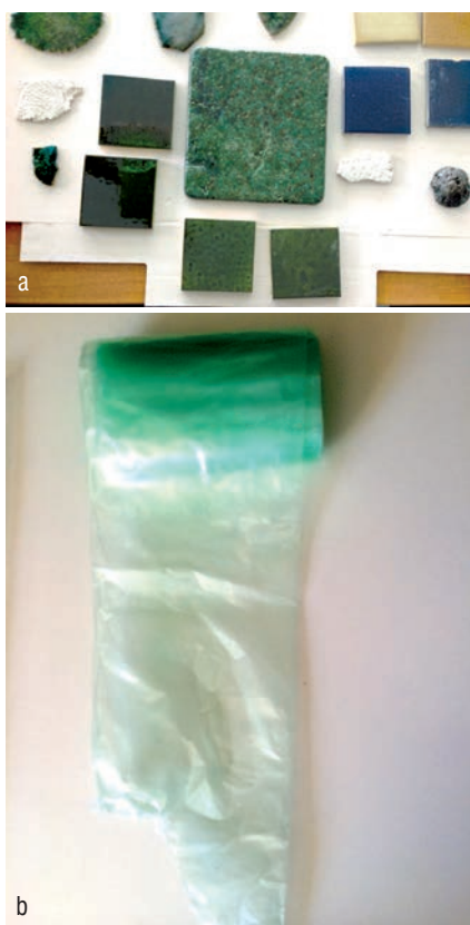
Fig. 4 Esempi di compositi realizzati con il COSMOS-RICE: a) piastrelle in ceramica e COSMOS-RICE, b) pellicola per imballaggio (verde) realizzata in PE e COSMOS-RICE, c) compositi in PP e COSMOS-RICE (orsetti), d) esempio di lastrina ottenuta impiegando il COSMOS-RICE come filler nel PMMA (materiale per la realizzazione dei lavelli)
