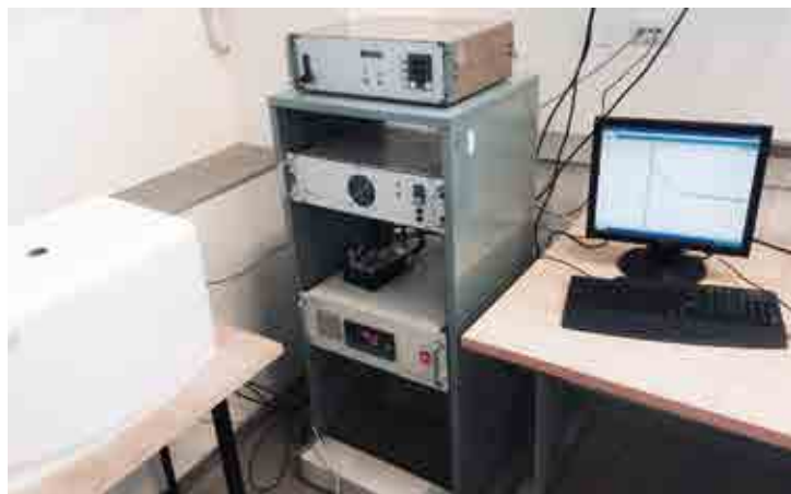
Apparato per misure SSNMR in bassa risoluzione, dotato di un campo magnetico di 0,5 T (pari ad una frequenza di Larmor dei nuclei ^1\text{H} di 21 MHz)
