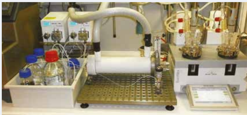
Fig. 4 Set up per il test di un processo continuo in condizioni criogeniche
