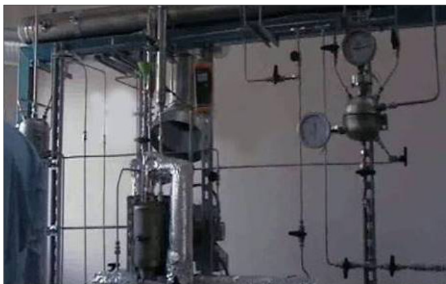
Fig. 1 - Particolare di prototipo per la produzione di biofuel da oli esausti di frittura
