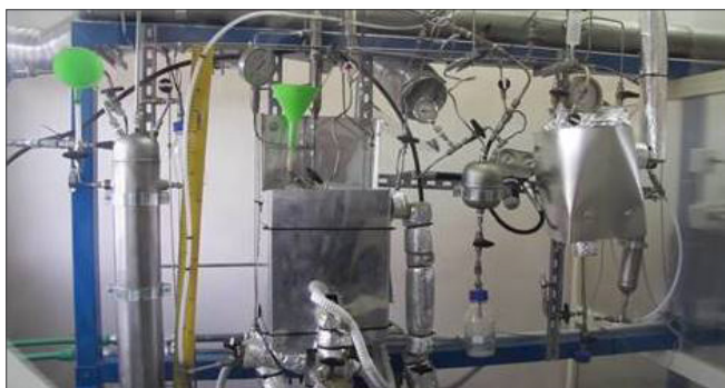
Fig. 2 - Particolare di prototipo per la produzione di biofuel da oli esausti di frittura
