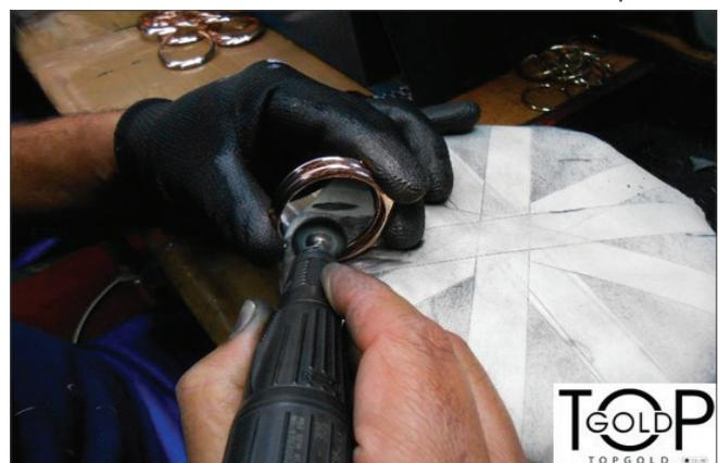
Fig. 3 - Esempio di dispersione di metalli preziosi durante il trattamento di finitura del gioiello. Diffusione foto acconsentita da Top Gold Srl
