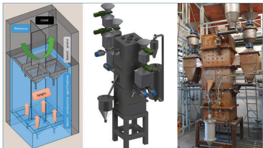
Fig. 3 - Interno, rappresentazione CAD e reattore sperimentale BIOCHAR
