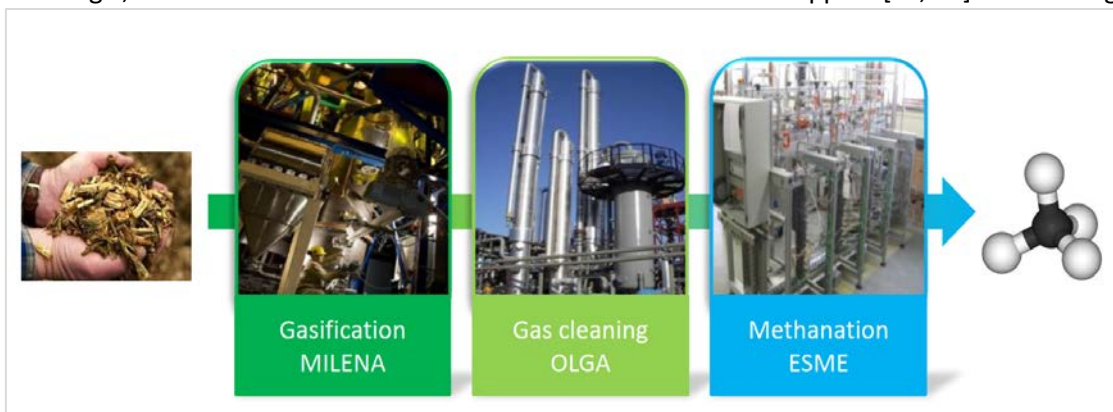
Fig. 3 - Schema del processo di Alkmaar
