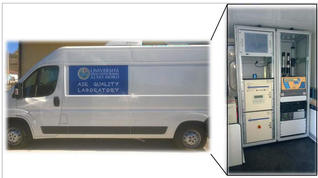
Fig. 1 - Laboratorio per il monitoraggio ad elevata risoluzione temporale della qualità dell'aria e caratterizzazione del PM
