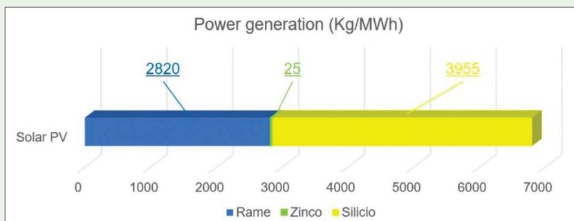
Fig. 4 - Materiali critici nel solare PV
