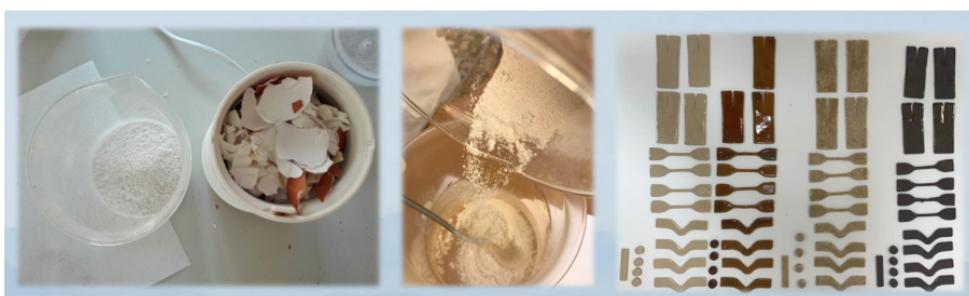
Figura 5. Fasi della lavorazione per arrivare allo stampaggio dei provini per le prove meccaniche e per la caratterizzazione cromatografica
