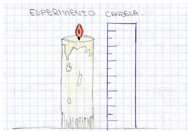
La combustione è probabilmente la prima reazione chimica con cui l'uomo ha avuto a che fare, è fondamentale per la vita, è analoga alla respirazione (Lavoisier). L'esperimento consiste nel misurare la lunghezza della candela in funzione del tempo, verificare che si tratta di una reazione di ordine zero (velocità costante) e di determinare la velocità di reazione in moli al secondo.
