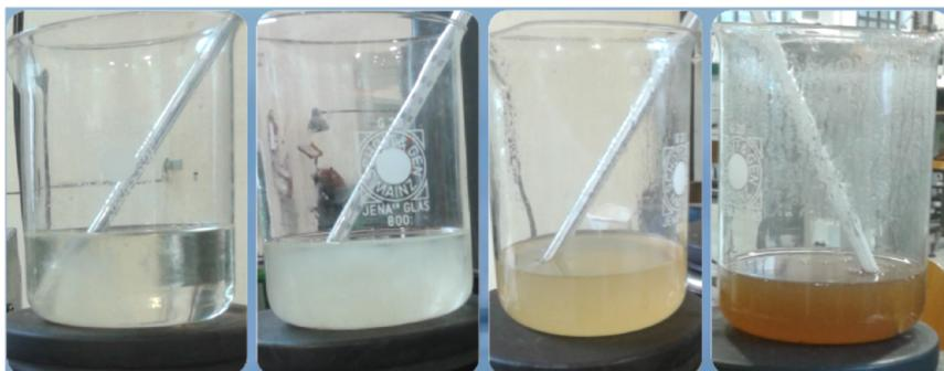
Figura 3. Varie fasi della polimerizzazione dell'acido lattico per semplice policondensazione
