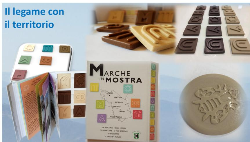
Figura 8. Materiali biocompositi a base PLA e scarti alimentari prodotti nei laboratori dell'ITT Montani di Fermo
