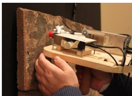
Figura. Misure di fluorescenza X in situ.
