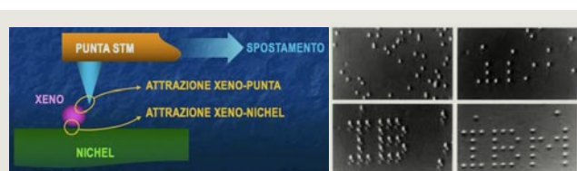
Fig. 14 Sequenza realizzata usando la punta del microscopio STM per spostare atomi di Xe su una superficie di Ni(110) (da Rif. [19]): fu la prima dimostrazione di nanomanipolazione a livello di singoli atomi; le lettere della scritta IBM hanno una dimensione di circa 50 Å
