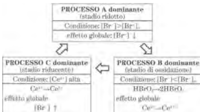
Schema 1. Meccanismo semplificato per la reazione BR (fonte: R. Cervellati, La Chimica e la Società, https://ilblogdellasci.wordpress.com/2015/04/03/le-reazioni-chimiche-oscillanti-1-parte/ )
