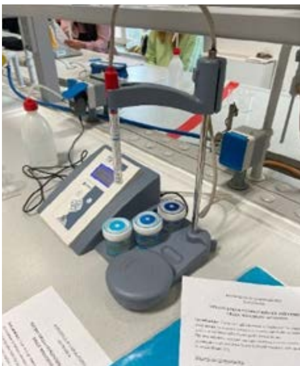
Figura 13. Conducimetro da banco con sistema di agitazione integrato
