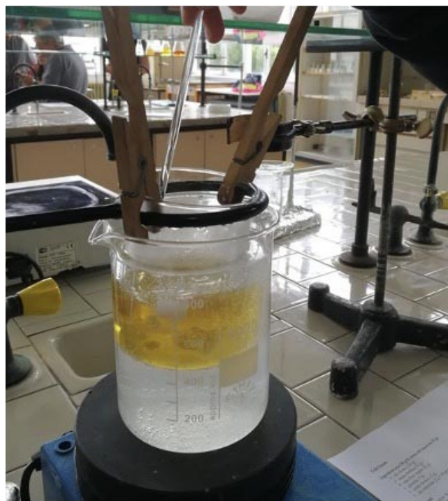
Fig. 5. Produzione della crema: bagnomaria per la fase lipidica
