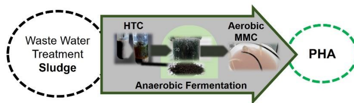
Figura 1: Il processo integrato B-PLAS DEMO accoppia trattamenti termochimici e fermentazioni microbiche per la produzione di PHA
