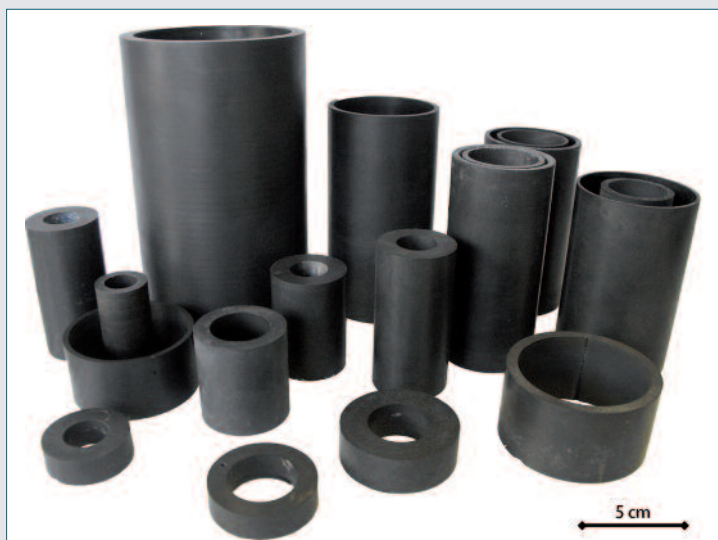
Fig. 4 - Oggetti di MgB_2 di varia forma e taglia ottenuti mediante la tecnica di Mg-RLI
