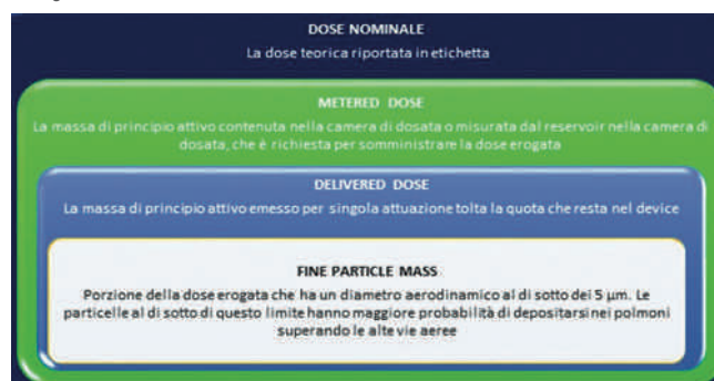
Fig. 5 - Principali parametri per la valutazione delle performance di un prodotto per inalazione
