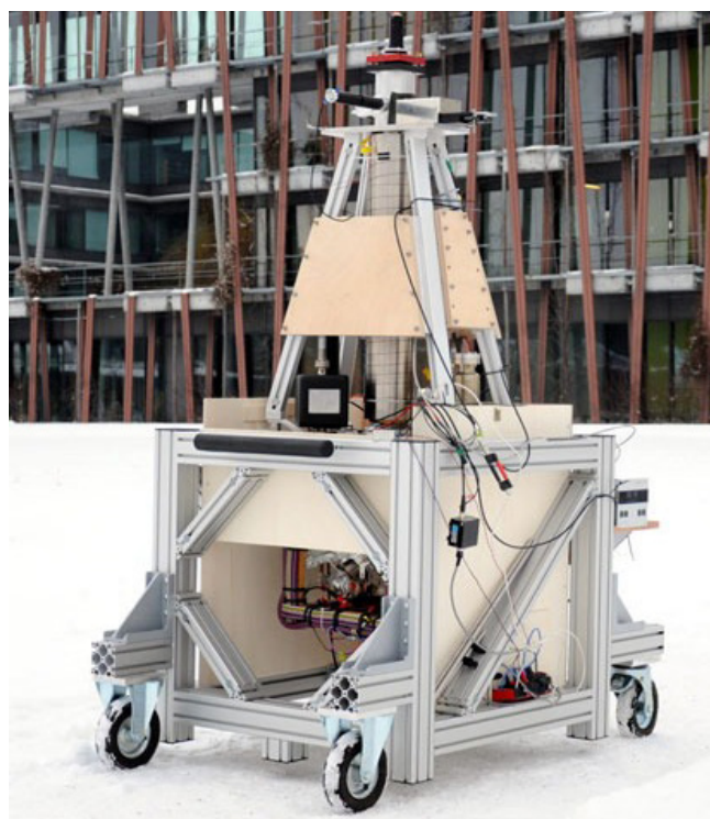
Fig. 3 - Parte del gravimetro atomico trasportabile descritto in [20]. A questo va aggiunto un armadio telefonico da 19 pollici contenente l'elettronica. L'intero sistema può essere trasportato in un furgone
