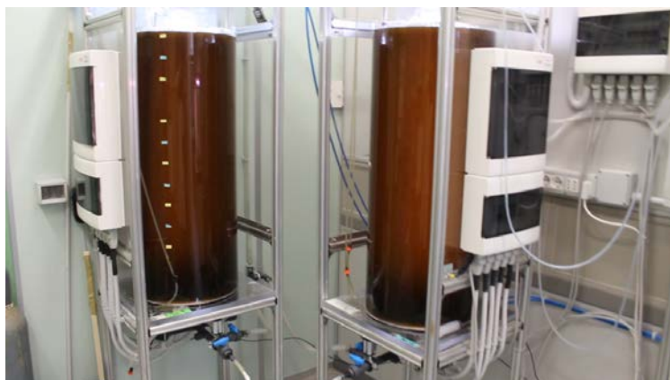
Coltivazione di Phaeodactylum tricorneratum in fotobioreattori da 70 litri (foto sopra). Sotto, colture batch (1 litro)
