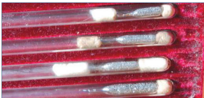
Fig. 4 - Particolare dei tubi di vetro contenenti alcune delle sorgenti di neutroni, radon-berillio, utilizzate da Fermi (Fondazione Domus Galilaeana, Pisa)
