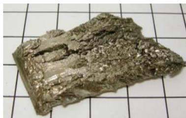
Figura 7. Campione di scandio cristallino ottenuto per distillazione.
