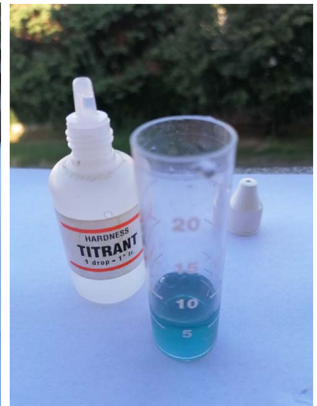
Determinazione della durezza dell' acqua con uso di un kit
