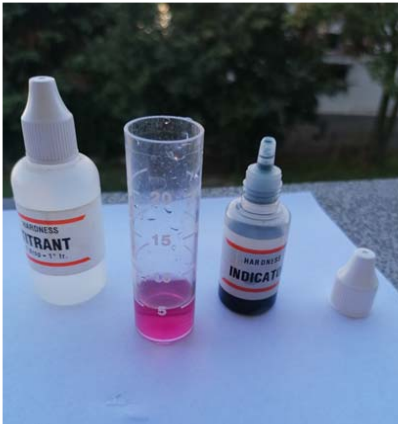
Determinazione della durezza dell' acqua con uso di un kit
