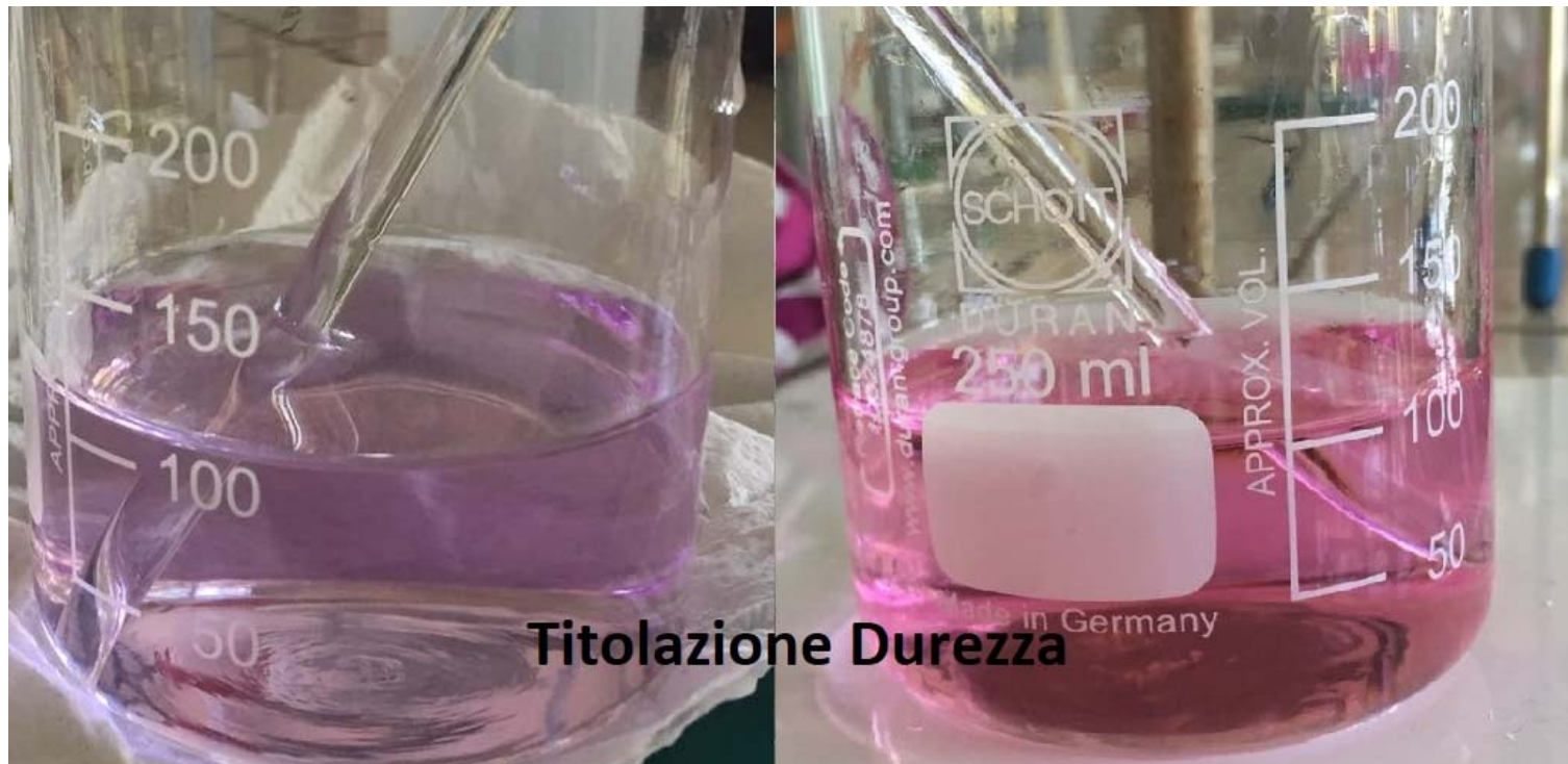
In figura viraggio dell'indicatore Muresside nella determinazione del Calcio con EDTA
