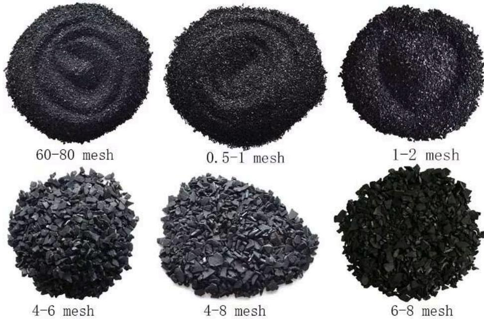
**Il carbone attivo** è carbone vegetale o animale che è stato trattato con anidride carbonica o vapore surriscaldato a temperature molto elevate. Questo trattamento aumenta la porosità del carbone e di conseguenza la superficie e si formano più spazi in cui le molecole possano restare intrappolate.
