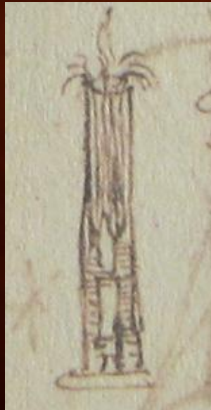
Colonna di vetro per osservare la produzione del fumo di una candela (Codice Atlantico, f. 226v)
