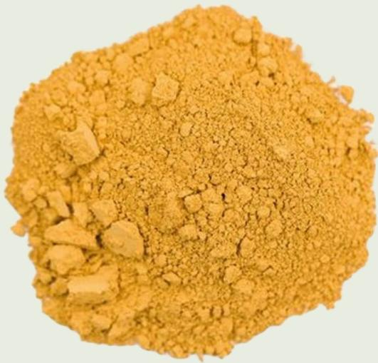
**ocra gialla:** limonite, miscela di minerali amorfi di Fe(III):  $\text{FeO}(\text{OH}) \cdot n\text{H}_2\text{O}$
