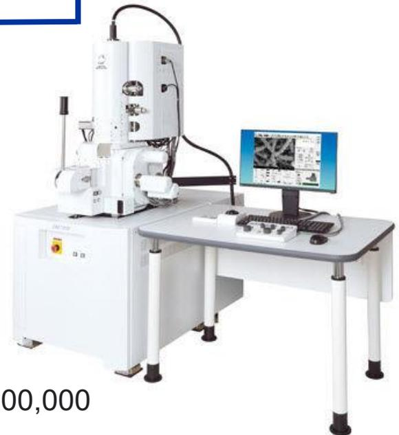
**Il microscopio elettronico a trasmissione (TEM) ha un potere risolutivo è di 0.2 nm**, circa  $5 \times 10^5$  volte maggiore di quello dell'occhio umano. **Il microscopio elettronico a scansione (SEM) ha un potere risolutivo di 10 nm**, quindi viene in un certo senso "superato" dal TEM, ma riesce a fornire delle **immagini tridimensionali**, che permettono di apprezzare i contorni e la forma delle strutture osservate.
