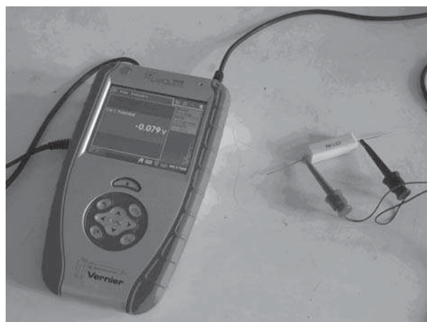
Figura 5: La resistenza 1,00 \Omega , la sonda per la misura della caduta di tensione e l'interfaccia LabQuest ® responsabile del campionamento e della digitalizzazione del segnale.
