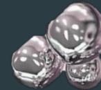
Sono state sintetizzate delle nanoparticelle d'argento per reazione tra nitrato d'argento e glucosio in ambiente basico.
