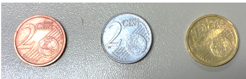
Figura 1. Fasi della tintura della moneta di rame.
