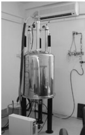
Figura 10: Esempio di spettrometro NMR per stato solido.
