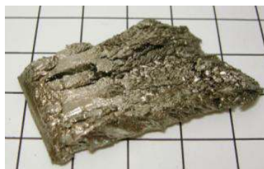
Figura 7. Campione di scandio cristallino ottenuto per distillazione.
