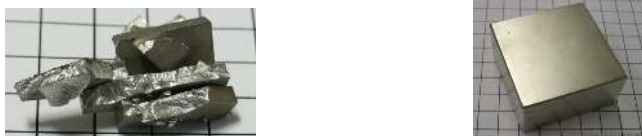
Figura 31. Foto a sinistra, pezzi frantumati di magneti di samario-cobalto \text{SmCo}_5 . Magnete al neodimio foto a destra.
