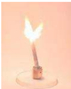
Figura 26. Fotogramma del filmato di combustione di una sigaretta in condizioni di alta concentrazione di ossigeno.
