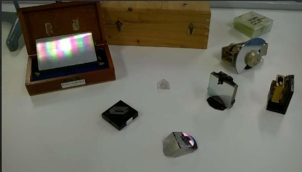
Alcuni elementi ottici utilizzati nelle dimostrazioni didattiche: reticolo di diffrazione (in alto a sinistra), prismi (al centro), specchi concavi, chopper e fenditure (a destra).
